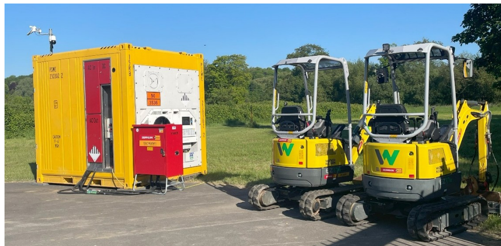
Glasfaserbaustelle im Wasserschutzgebiet: Elektrisch betriebene Maschinen und Batteriespeicher von Zeppelin Rental ermöglichen Baustellenbetrieb unter sensiblen Umweltauflagen
